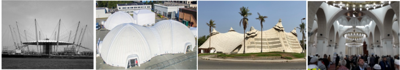
شكل (4) نظام الإجهاد الواحد Single Stress العقود والخيام والمنشآت الهوائية المنفوخة والمنشآت المعلقة
